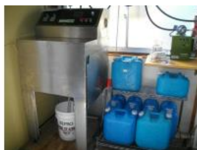
「バイオディーゼル燃料の精製器」
